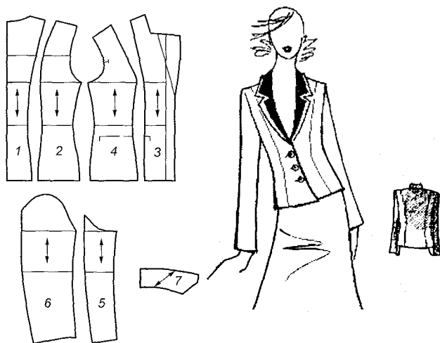
Рис. 4.4. Эскизы и наименование основных деталей женского жакета 1) центральная часть спинки, 2) боковая часть спинки, 3) центральная часть полочки, 4) боковая часть полочки, 5) нижняя часть рукава, 6) верхняя часть рукава, 7) нижний воротник
